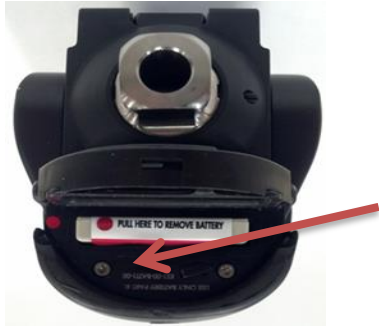
Zone du compartiment à batterie
